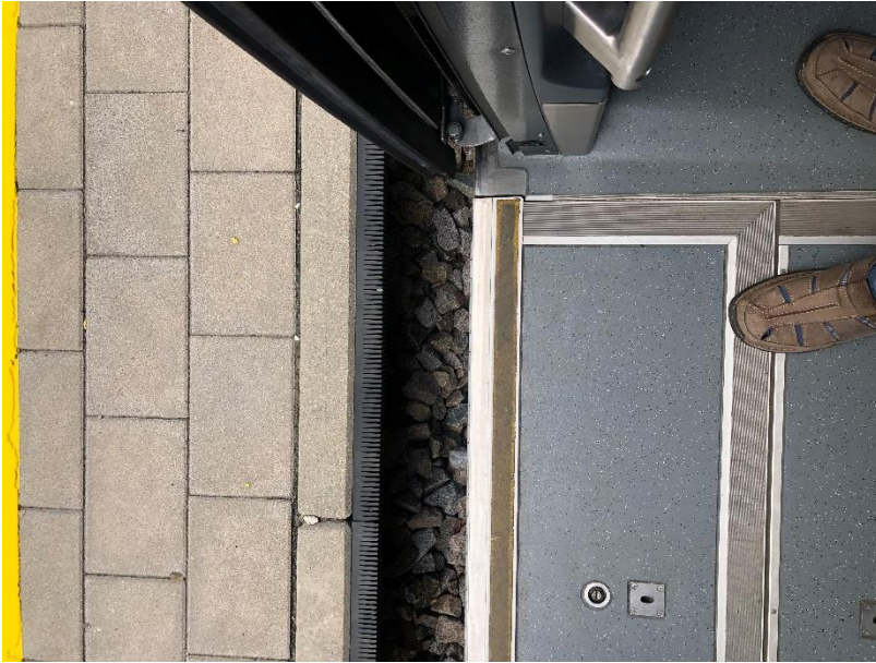
Abbildung 4: Spalt zwischen einem Triebwagen der Reihe 500 und dem Bahnsteig der Haltestelle Pfaffstätten-Rennplatz in Fahrtrichtung Wien Oper am 7. August 2024
