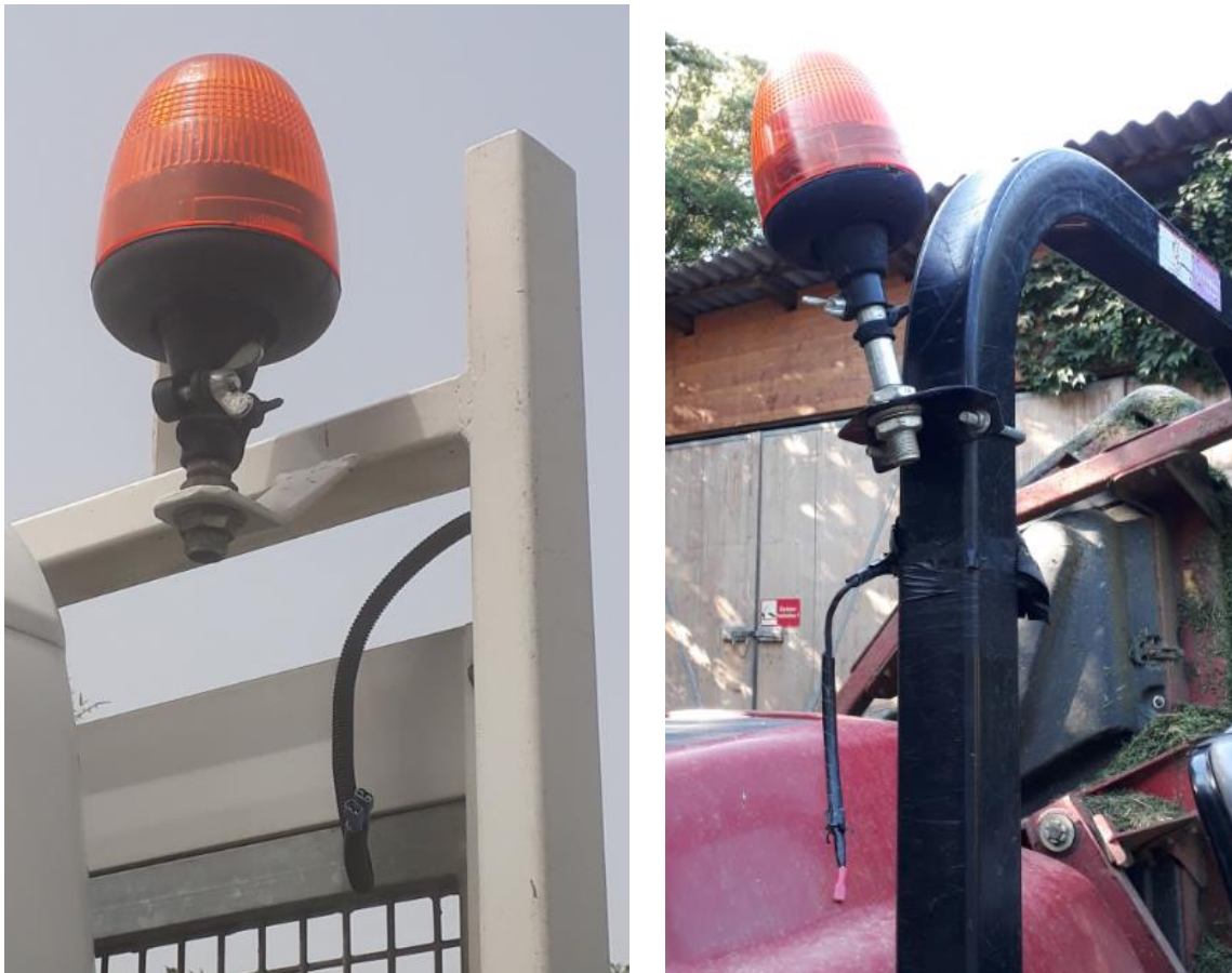
Abbildungen 1 und 2: Rundumleuchten mit abgerissenem Kabel
