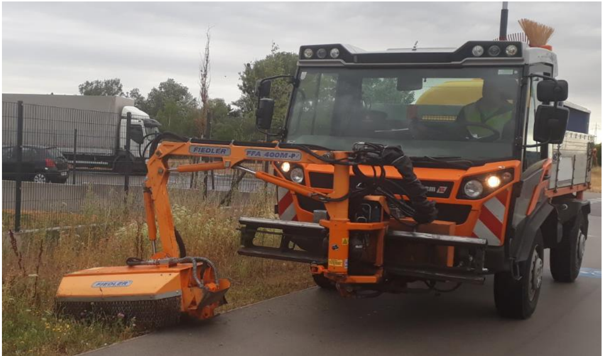
Abbildung 20: Böschungsmäher im Einsatz
