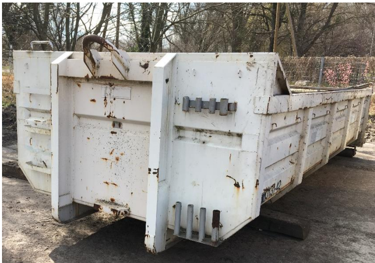
Abbildungen 9 und 10: Abgenutzter Aufnahmebügel
