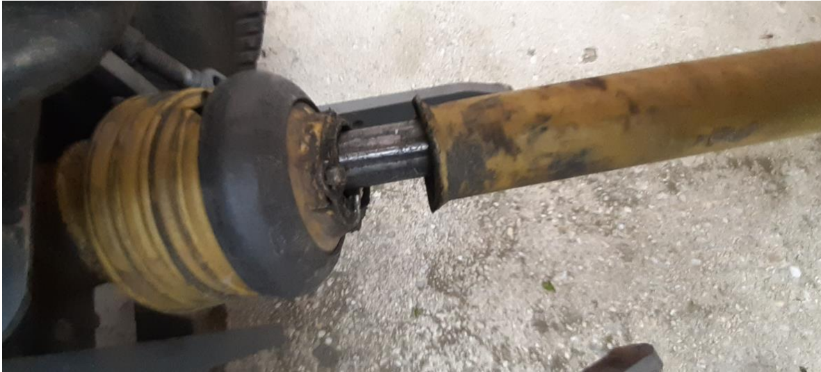
Abbildungen 5 bis 7: Beschädigte Antriebswellen- bzw. Drehwellenabdeckungen
