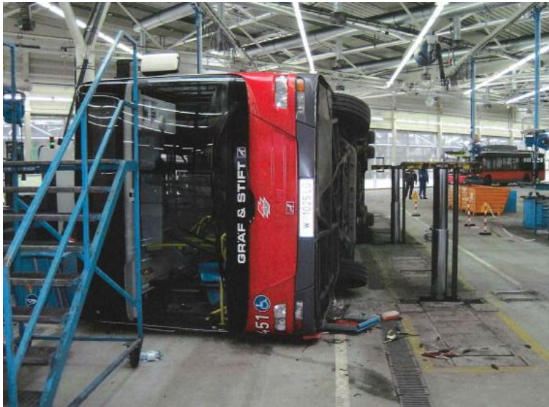
Abbildung 1: Von der Stempelhebebühne gestürzter zweiachsiger Autobus
