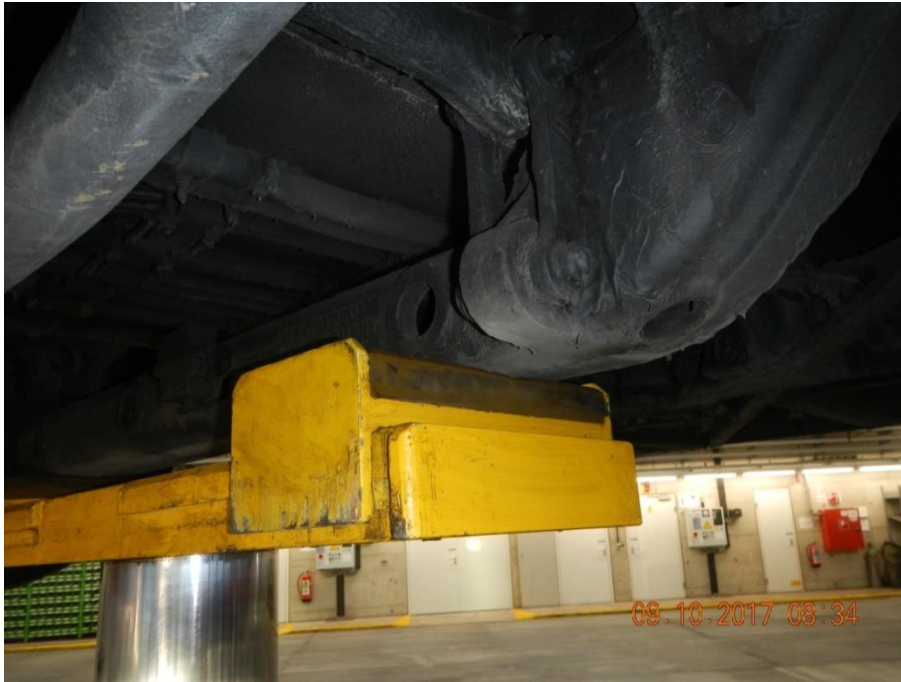
Abbildung 5: Aufnahmeschieber auf der vorderen Kopfplatte der Stempelhebebühne
