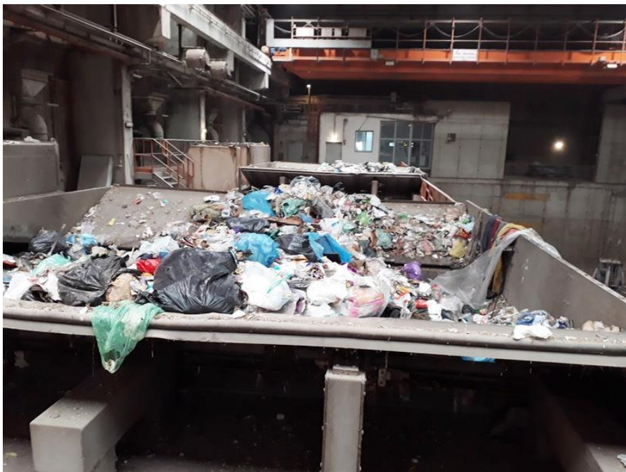
Abbildung 3: Ansicht der Müllaufgaben im Tiefbunker (Schubböden)
