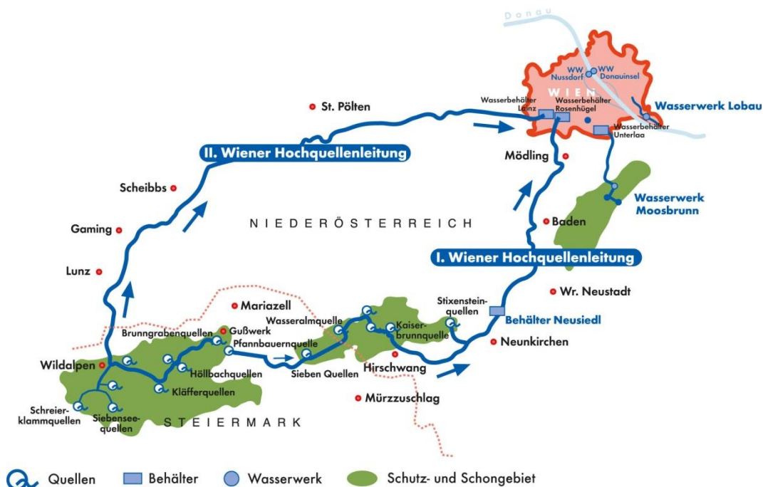
Abbildung 1: Leitungsführung der Wasserversorgung der Stadt Wien
